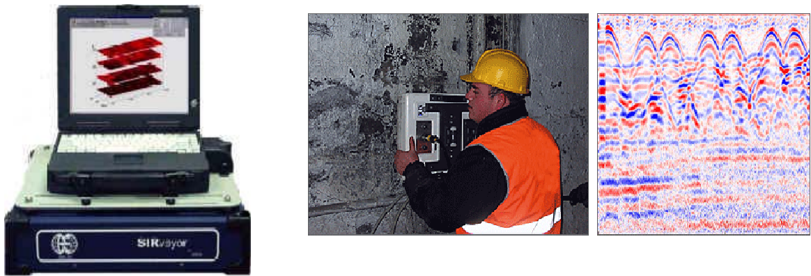
Figura 1: Passaggio dell'antenna su di una parete portante e restituzione grafica del segnale.
